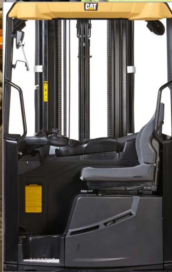
Visibilité exceptionnellement nette de l'opérateur (sur la gauche et vers le bas) grâce au positionnement judicieux des câbles et des flexibles et à l'intégration des vérins hydrauliques dans le profil du mât (à l'extrême gauche).
